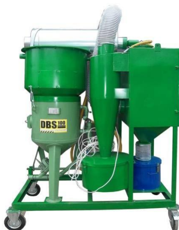
Рисунок 12 – Дробеметная установка Метобласт-100
