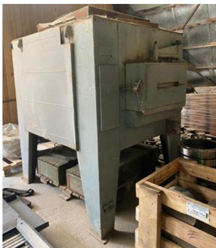
Рисунок 4 – Электрическая печь для отпуска и закалки детали
