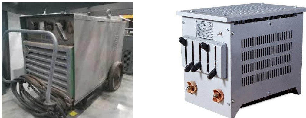
Рисунок 3 – Сварочный выпрямитель ВД-301 и балластный реостат РБ-400
