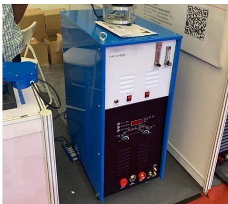
Рисунок 21 – Источник питания LHM-200 для питания сжатой дуги
