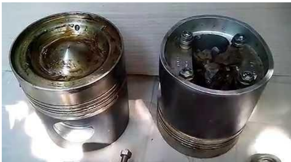
Рисунок 3 – Подлежащий восстановительной наплавке поршень судового дизеля
