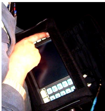
Рисунок 9 – Работа ультразвукового дефектоскопа УД2-102
