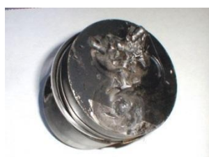
Поверхность поршня до восстановления
