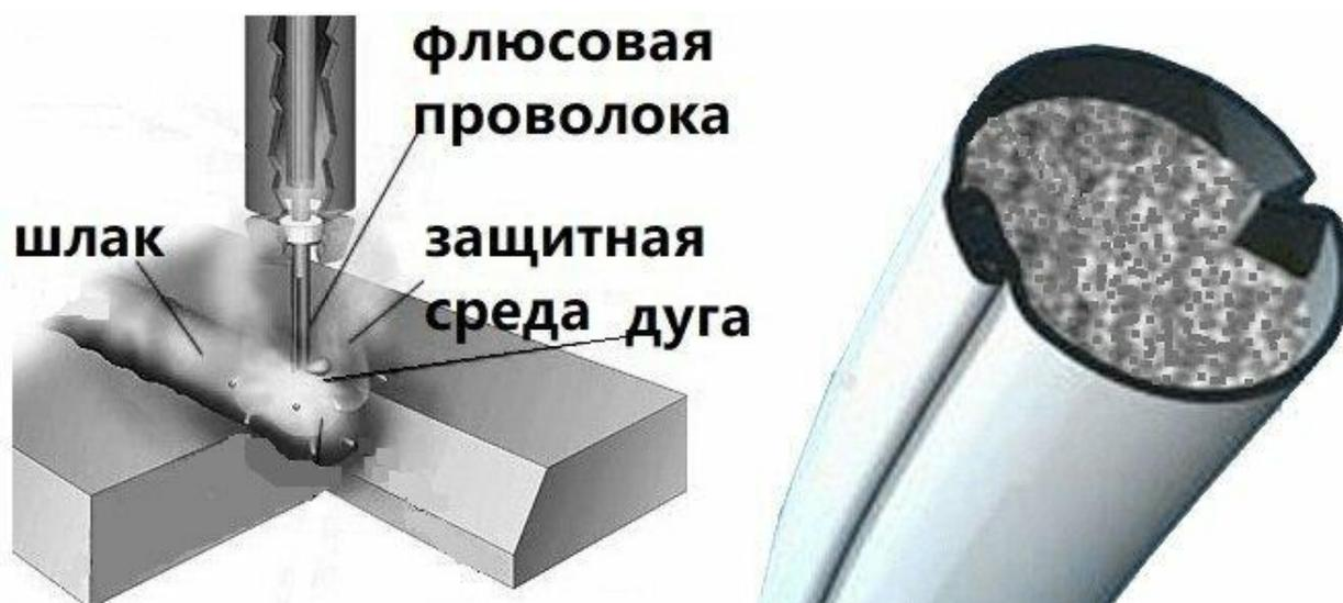
Рисунок 21 – Схема выполнения сварки самозащитной порошковой проволокой
