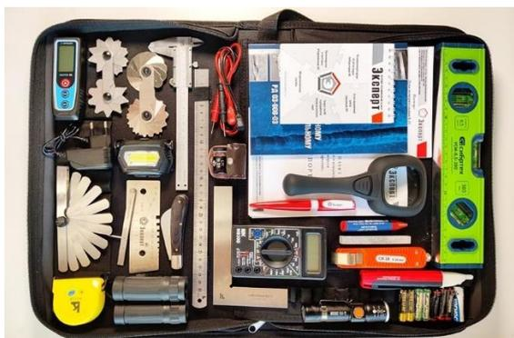
Рисунок 16 – Набор для проведения визуально-измерительного контроля
