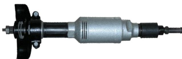
Рисунок 12 – Радиальная шлифовальная машина ИП-2014
