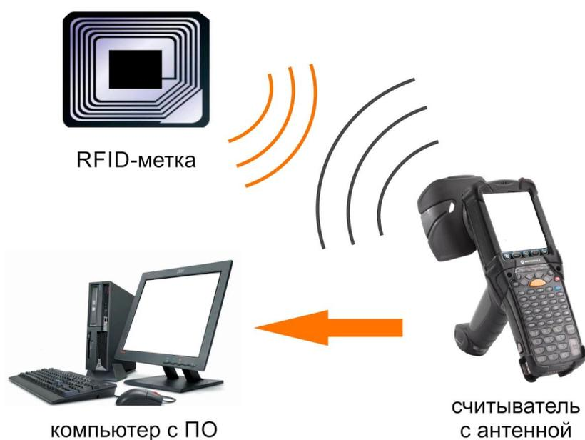
Рисунок 2 – Схема взаимодействия RFID
