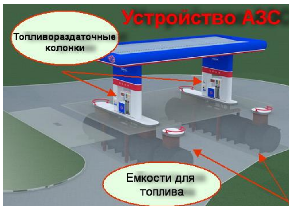
Рисунок 1 – Размещение основного оборудования АЗС
