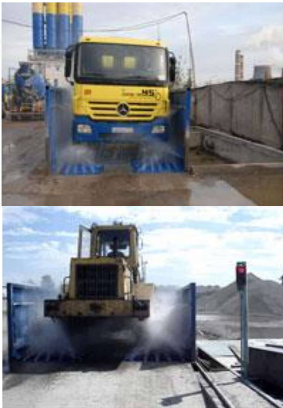
Рисунок 6 – Установка для мойки днищ и колес большегрузного транспорта Monsuna
