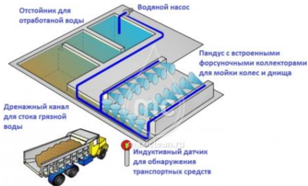
Рисунок 4 – Автоматическая мойка колес и днища грузового автотранспорта АМКД-2
