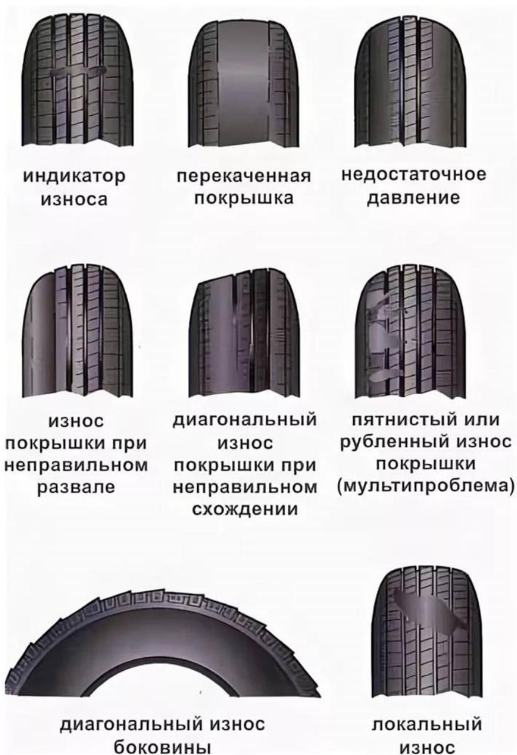
Рисунок 5 – Виды износа шины
