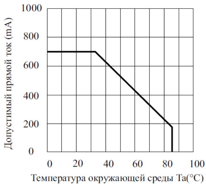
Рисунок 22 - Отношение допустимого прямого тока и температуры окружающей среды для светодиода 3HPD1
