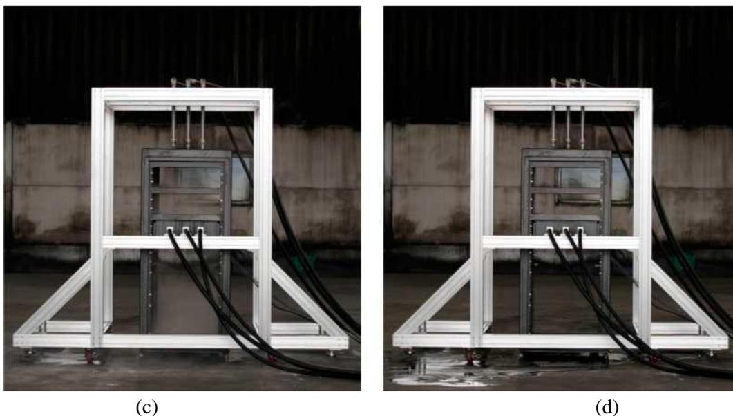
(а) испытательная установка, (б) тепловой разгон ячеек внутри модуля блока, (с) выброс огнетушащего вещества и (д) после тушения пожара в модуле блока
