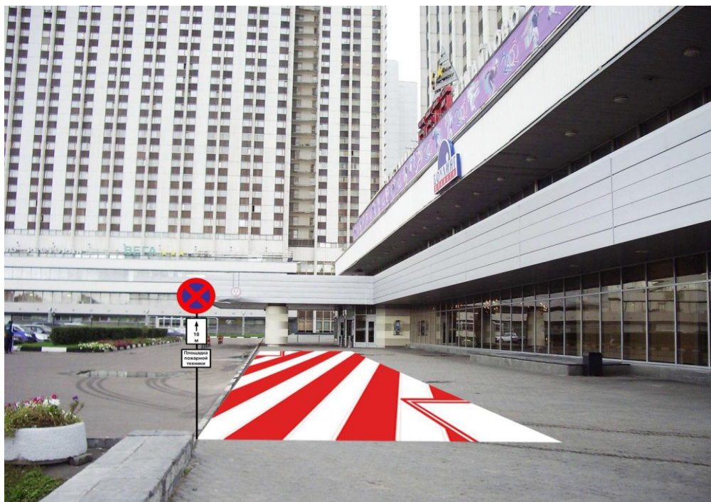
Рисунок А.3 - Образец размещения площадки для расстановки пожарной техники (автолестниц, коленчатых и телескопических автоподъемников)
