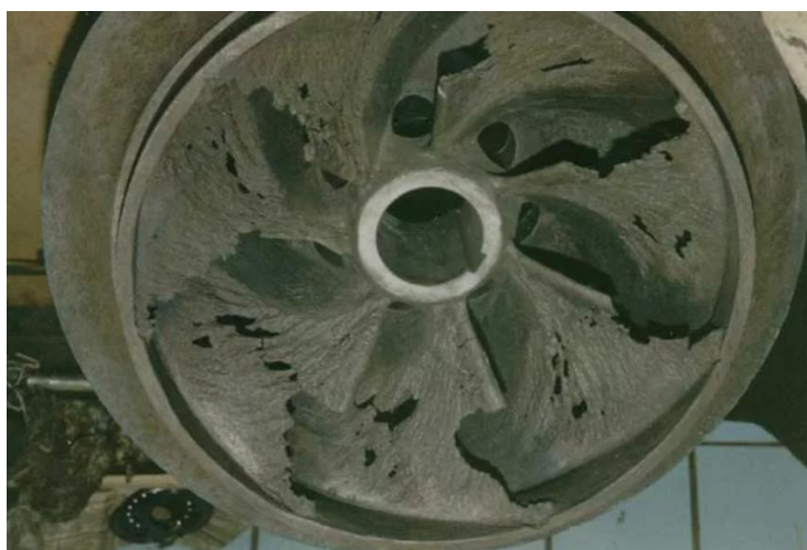
Рисунок 9 - Повреждение лопастей и основания турбины насоса гидроударами и кавитацией.
