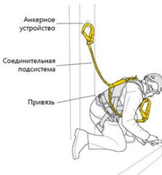
Рисунок 3 – Система обеспечения безопасности работ на высоте
