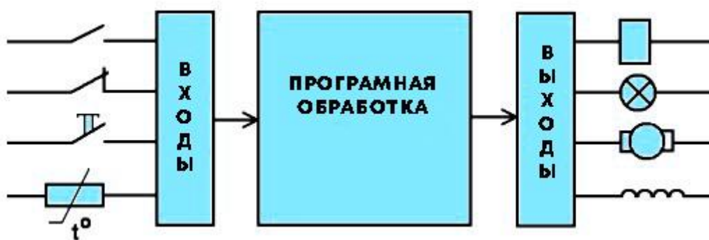
Рисунок 1 – Иллюстрация функциональных блоков ПЛК [27]
