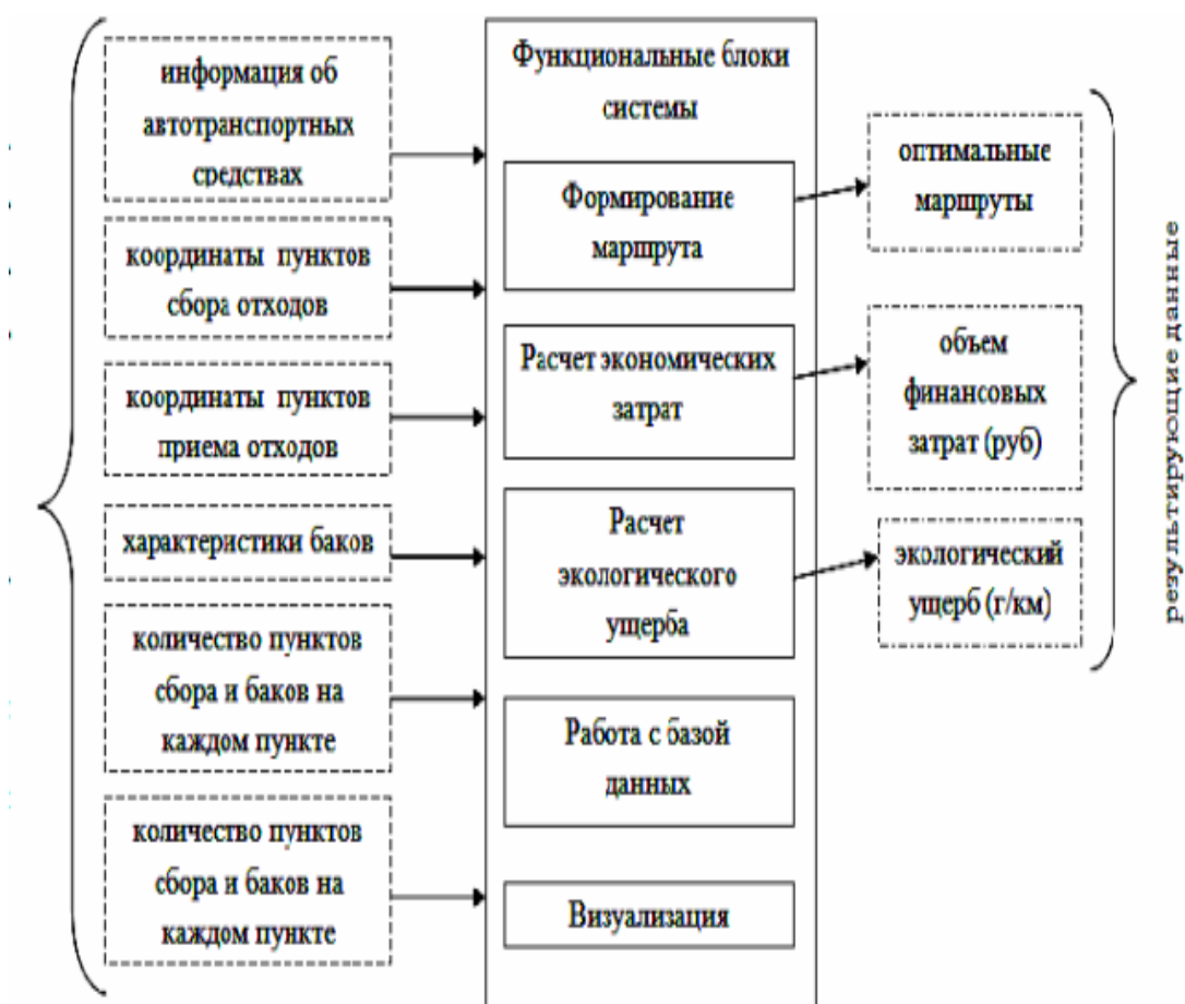
Рисунок 4 – Функциональная структура и логика работы АИС УЛО
