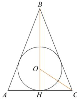
Рисунок 42 – Сечение комбинации цилиндра и шара.
