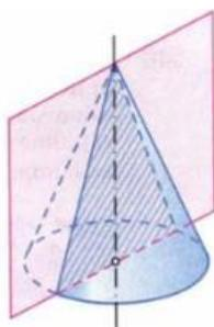
Рисунок 5 – Осевое сечение конуса плоскостью  $\alpha$ ,
