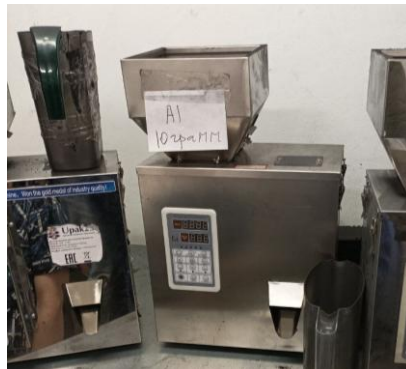
Рисунок А.1 – Дозатор весовой для сыпучих продуктов Qiangshou Packing Machinery co.
