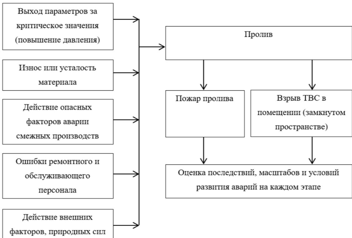
Рисунок 2 – Схема сценариев развития аварий в помещении (замкнутом пространстве)
