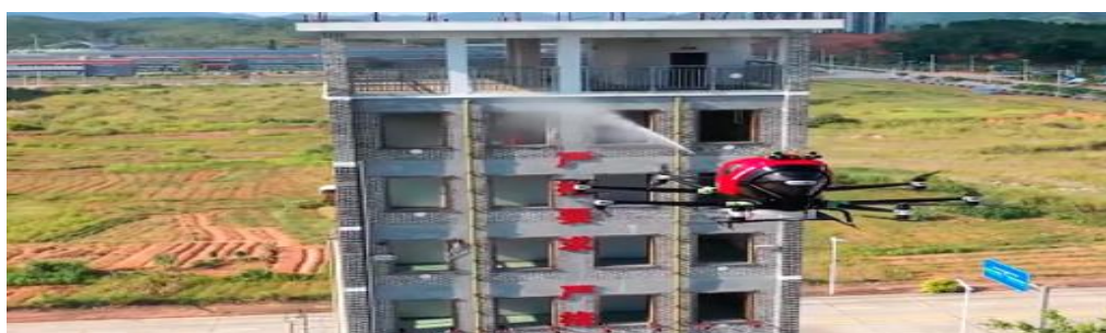
Рисунок 22 – Проведение испытания тушения дроном ЕХанг-216
