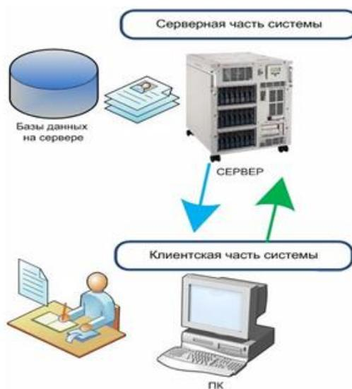
Рисунок 21 – Двухуровневая архитектура «Клиент-Сервер»
