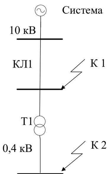
Рисунок 7 – Схема для расчёта токов КЗ в системе электроснабжения многоэтажной жилой застройки
