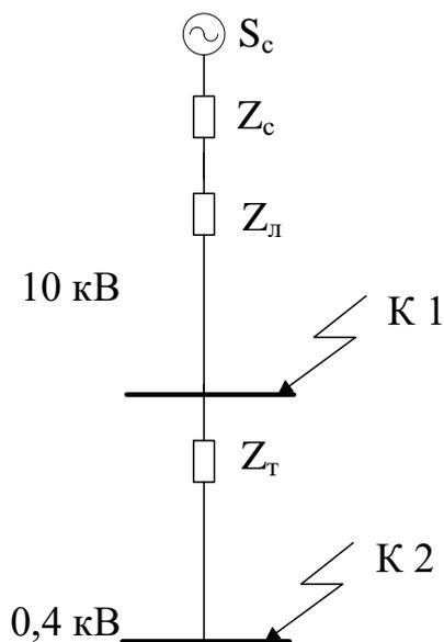
Рисунок 8 – Эквивалентная схема замещения для расчёта токов КЗ в системе электроснабжения многоэтажной жилой застройки
