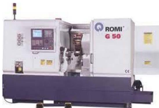
Рисунок 4 – Токарный станок с числовым программным управлением марки ROMY G50
