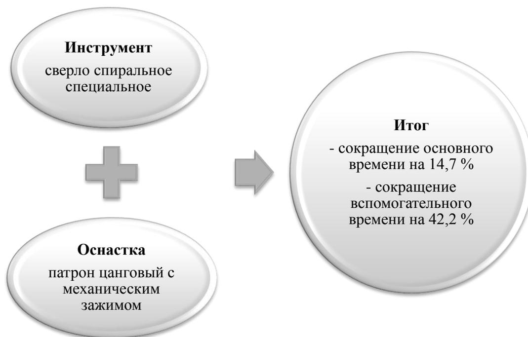
Рисунок 6 – Результат принципиальной переделки технологии и ее итог
