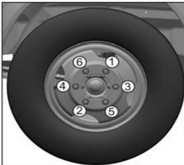
Рисунок 12 – Очередность затяжки гаек крепления колеса
