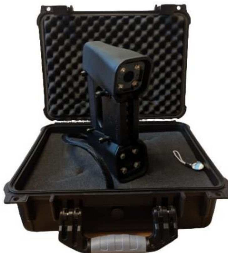
Рисунок 7 – аппарат для 3Д сканирования объектов Scanform L5
