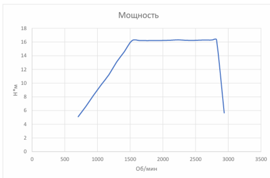
Рисунок 23 – График зависимости мощности от частоты вращения с испытаний
