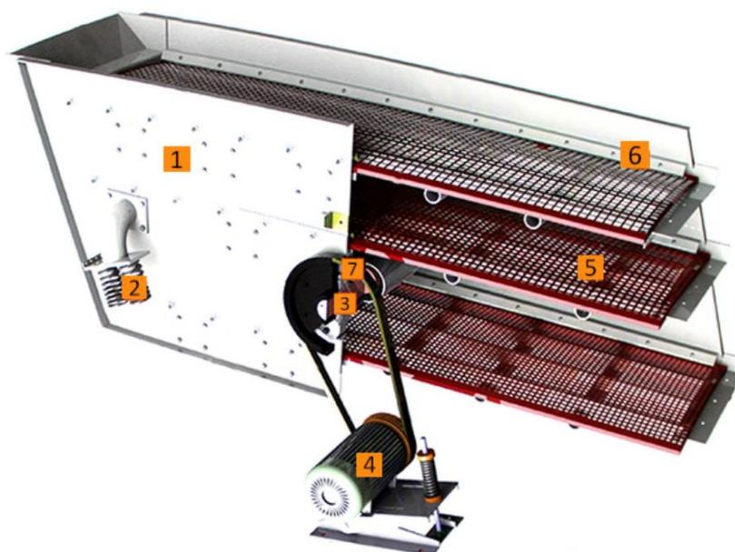
1 – корпус грохота, 2- пружина, 3 –вал, 4 – электродвигатель, 5 – сита, 6 – накладка, 7 – вибратор с дебалансом
