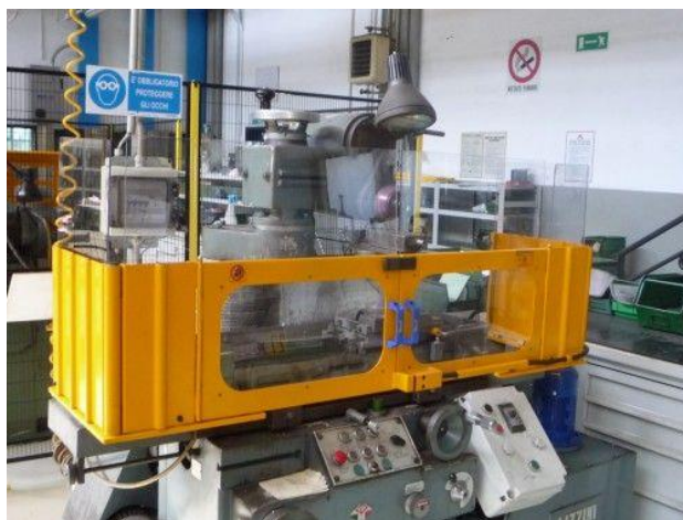
Рисунок 11 – Фрезерный станок со звукоизолирующим кожухом из оргстекла
