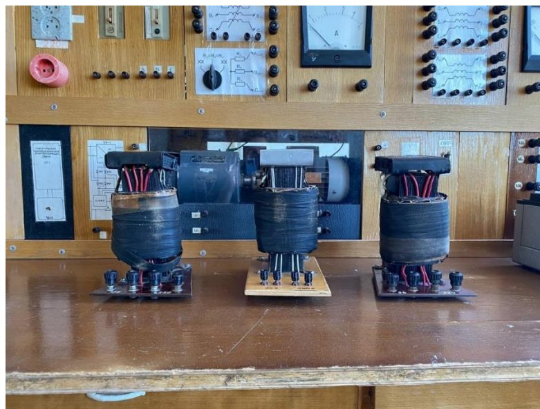
Рисунок 22 – Ранжированная группа трансформаторов
