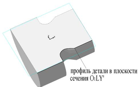
Рис. 5.16. Профиль детали в сечении
