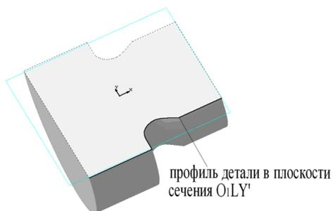
Рис. 4.4. Проекция профиля детали в плоскости  $O_1LY'$
