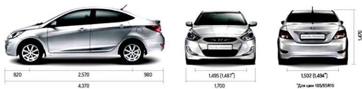
Рисунок 1 – Автомобиль марки Hyundai Solaris
