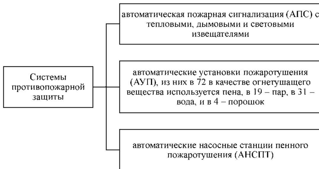
Рисунок 9 – Перечень наиболее распространённых системы противопожарной защиты, которые на сегодняшний день нашли широкое применение
