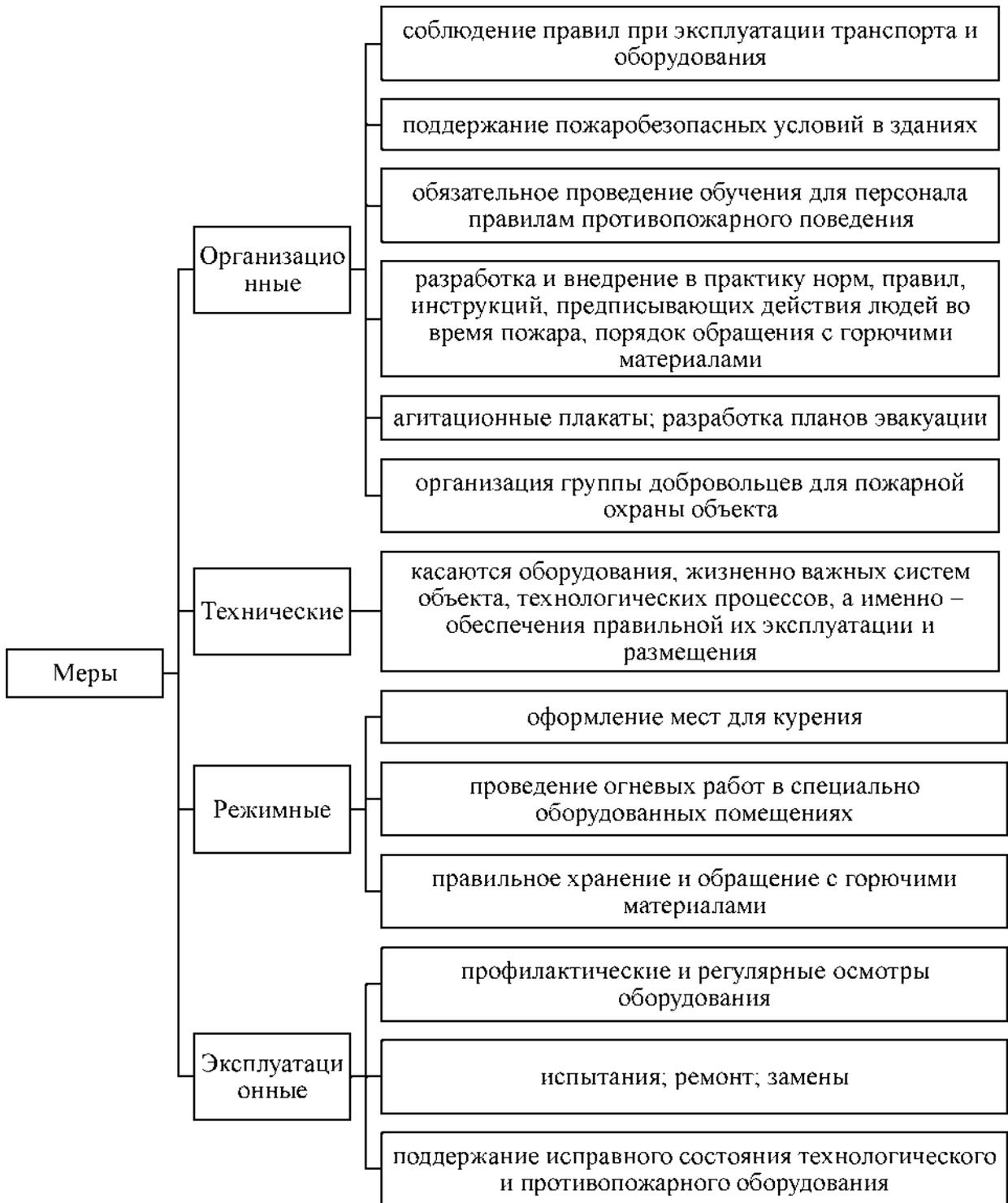
Рисунок 8 – Меры и структурные элементы противопожарной защиты на объектах железнодорожной отрасли
