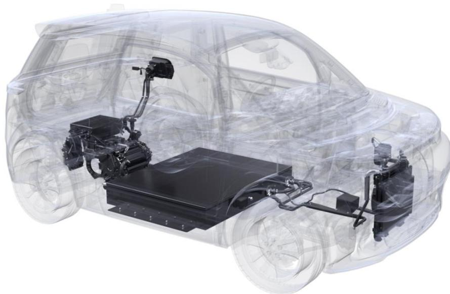
Рисунок 8 – Схема силовой установки Кама-1
