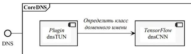
Рисунок 16 – Схема работы модуля CoreDNS.
