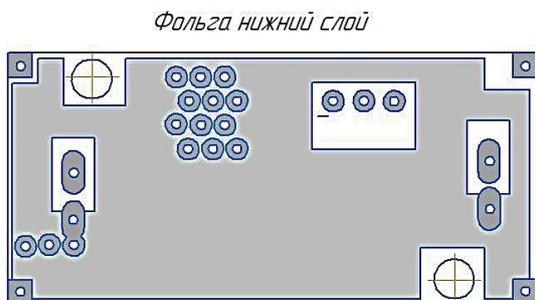
Рисунок 17 – Печатная плата DC/DC преобразователя
