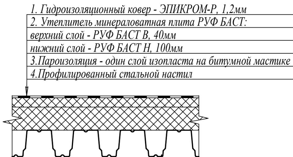
Рис.1 Конструкция покрытия
