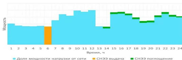
Рисунок 11 – График изменение мощности при применении СНЭЭ [5]
