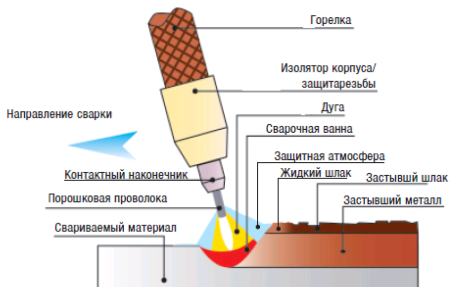
Рисунок 11 – Схема выполнения механизированной сварки самозащитной порошковой проволокой
