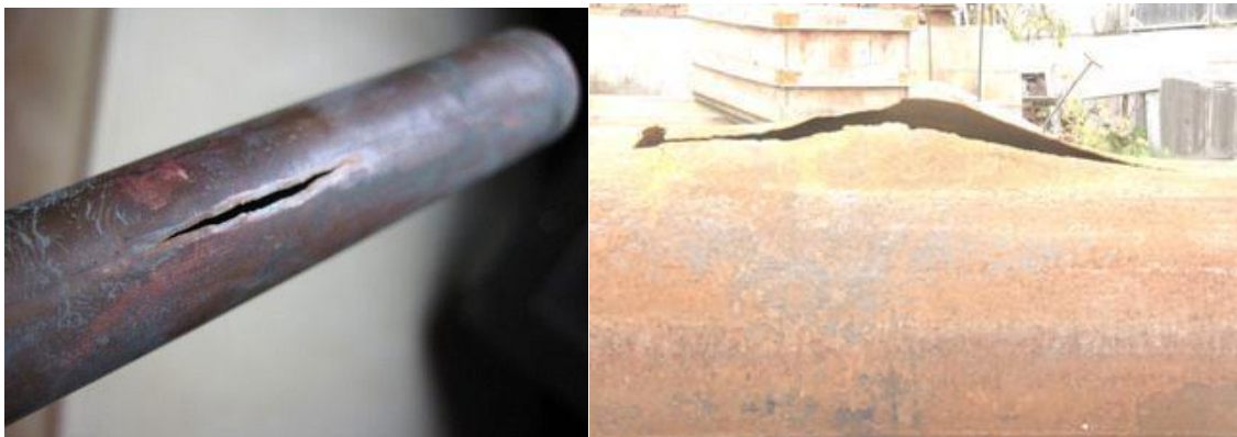
Рисунок 3 – Примеры участков трубопроводов, подлежащих переварке
