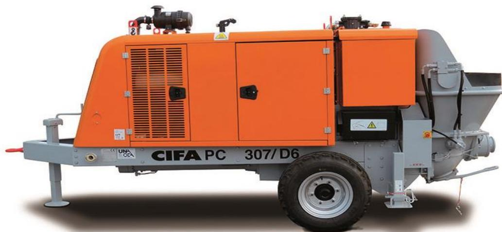
Рисунок 9 – Бетононасос Cifa PC307
