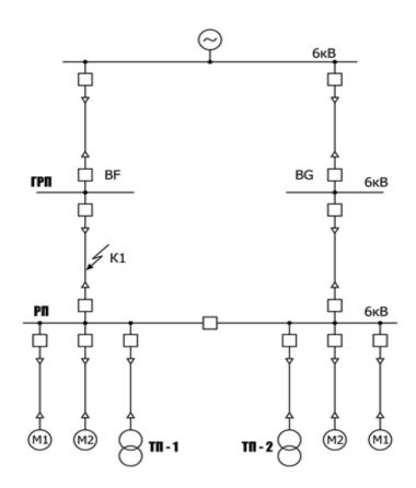
Рисунок 1 - Магистральная схема системы электроснабжения объекта
