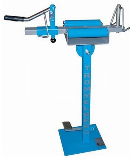
Рисунок 3.2 - Борторасширитель Trommelberg TS M201
