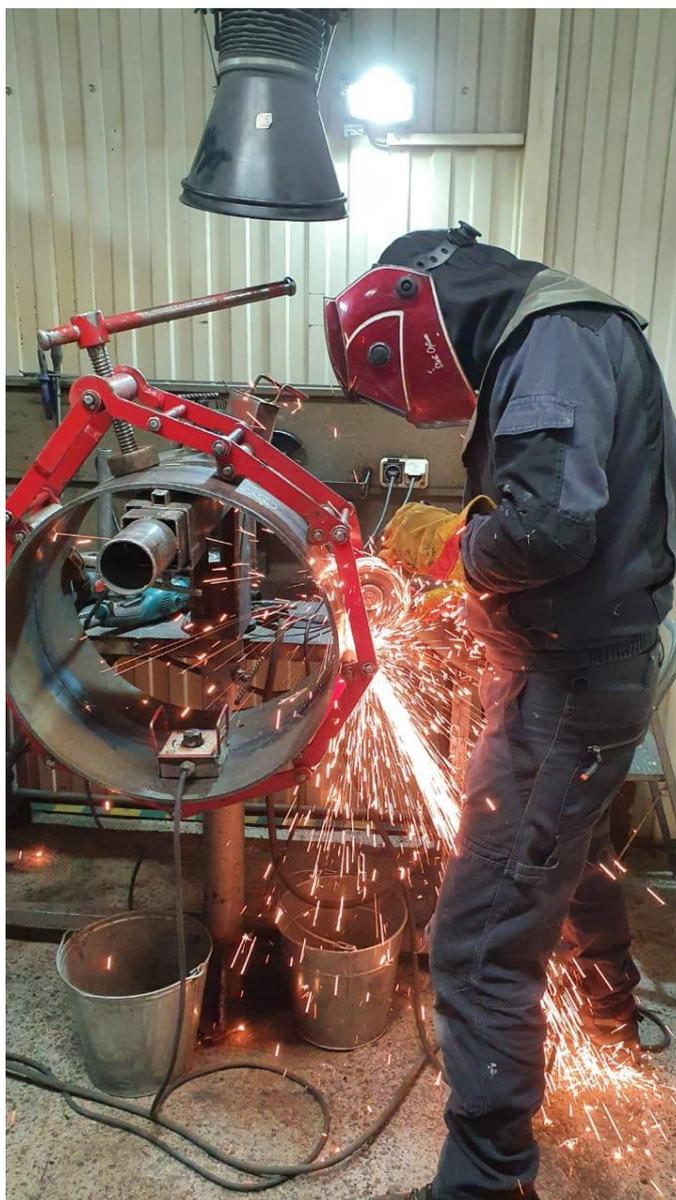
Рисунок 35 – Удаление прихваток с помощью шлифмашинки
