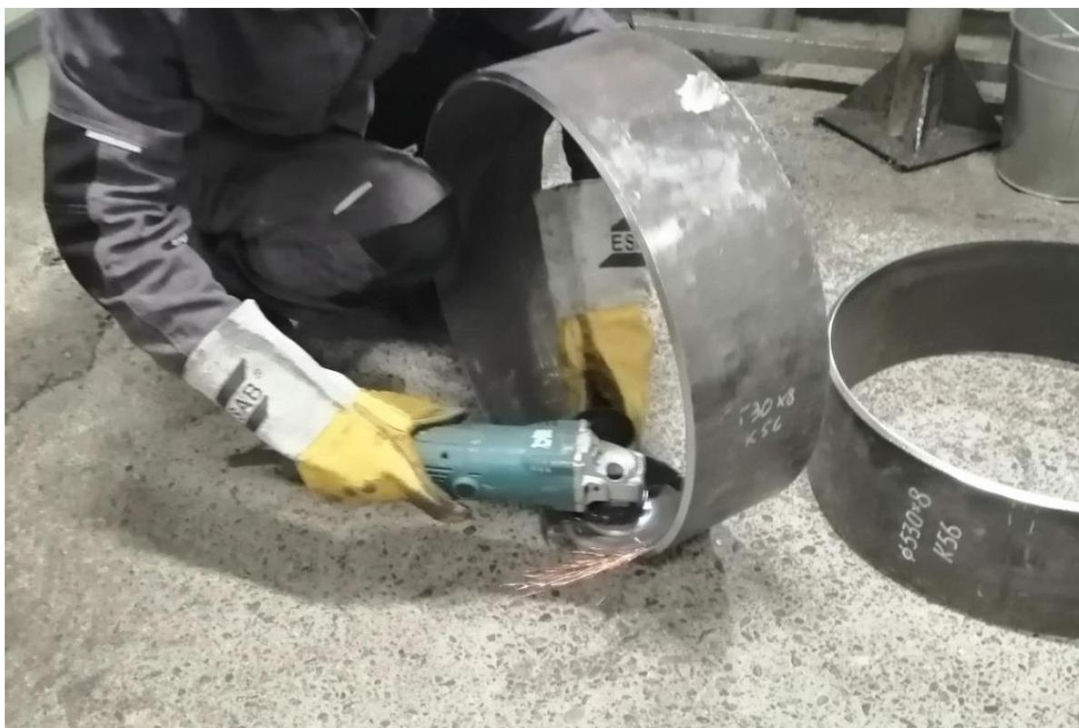
Рисунок 30 – Очистка кромок и концов труб
