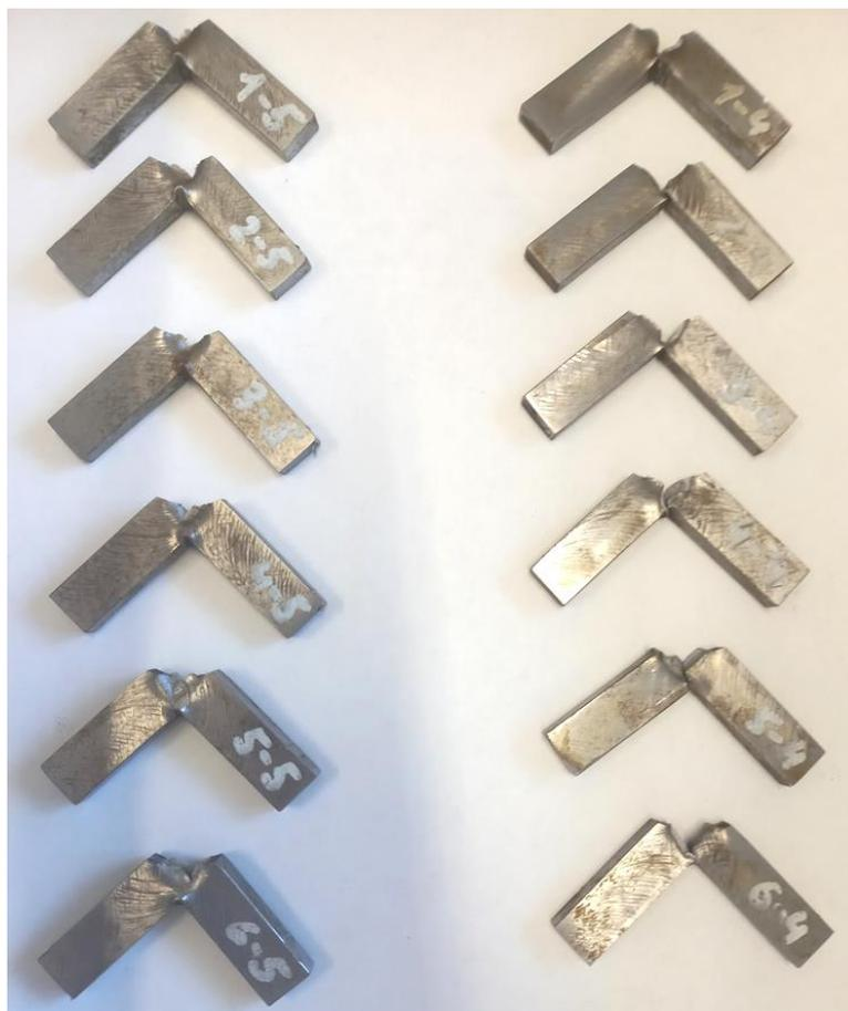
Рисунок 47 – Образцы после испытания на ударный изгиб
