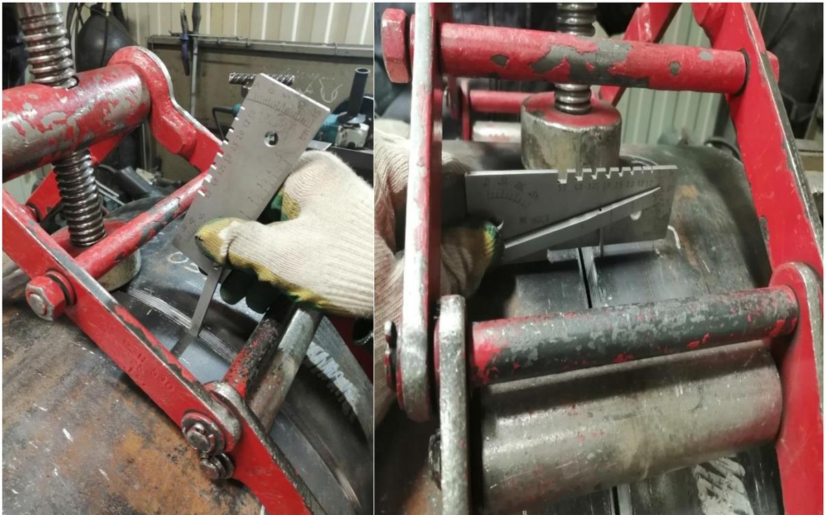
Рисунок 33 – Измерение собранного стыка шаблоном сварщика УШС-3
