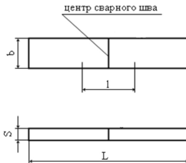
$b$  – ширина образца;  $L$  – общая длина образца;  $S$  – толщина основного металла
