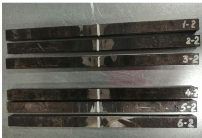
Рисунок 40 – Образцы для проведения испытаний на статическое растяжение
