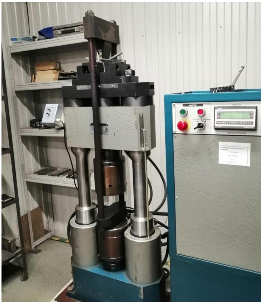
Рисунок – 22 Общий вид разрывной машины с установленным образцом
