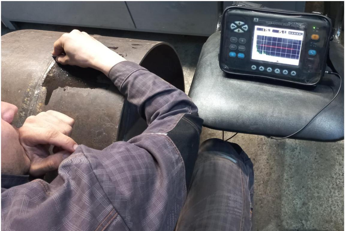
Рисунок 38 – Ультразвуковой контроль контрольного сварного соединения
