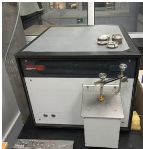
Рисунок 28 – Искровой спектрометр «Искролайн 100»
