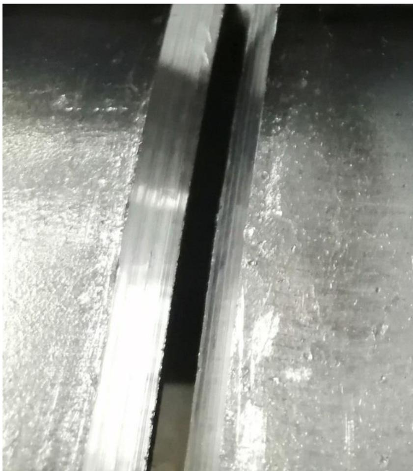
Рисунок 31 – Подготовленные кромки под сварку
