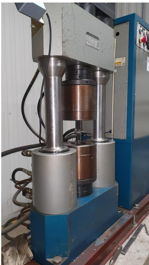
Рисунок 19 – Разрывная машина РМ-50
