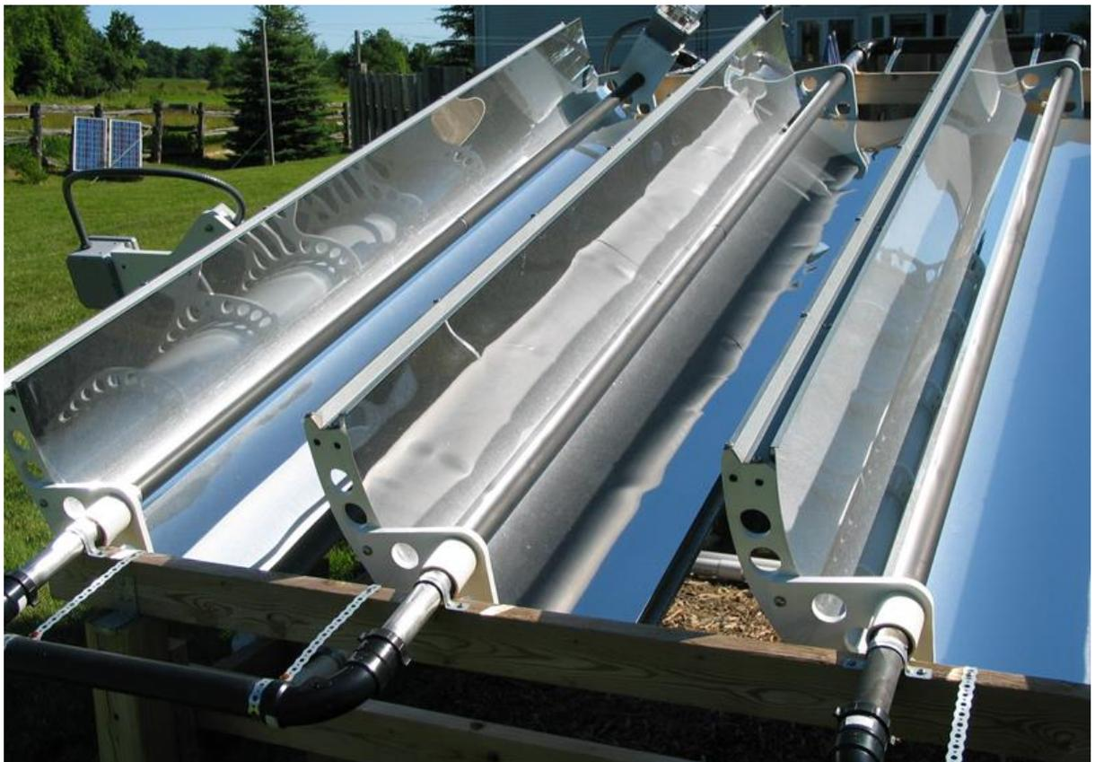
Рисунок 28 – Концентратор с системой гелиослежения
