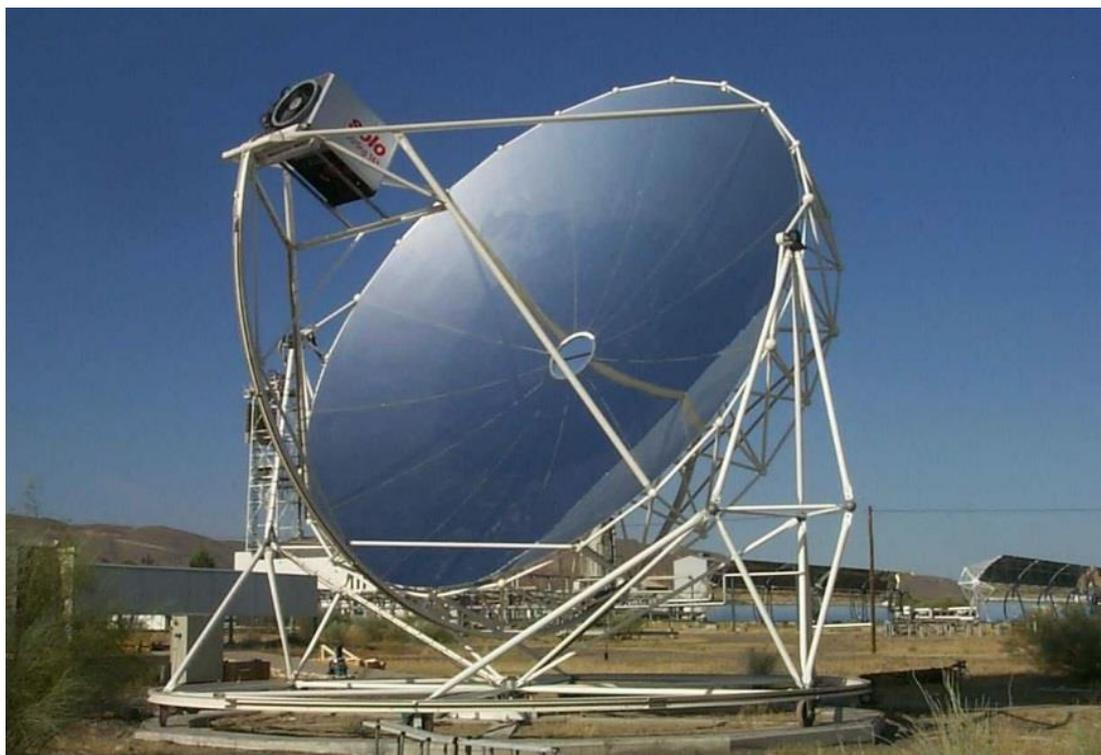
Рисунок 30 – Параболический концентратор с двигателем Стирлинга для совместной выработки тепловой и электрической энергии
