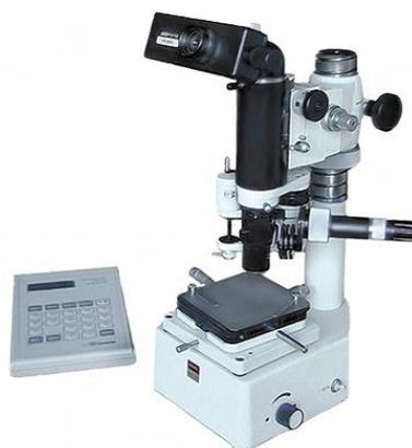
Рисунок 8 – Микротвердомер ПМТ-3М
