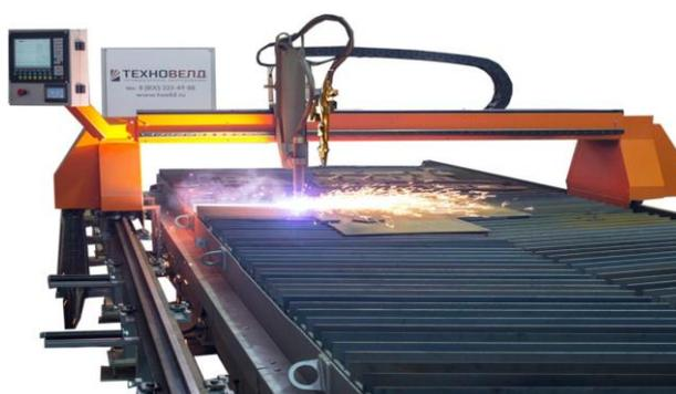
Рисунок 4 – Плазмарез TECHNOCUT
