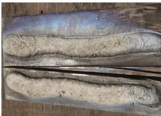
Рисунок 13 – Внешний вид наплавленных образцов
