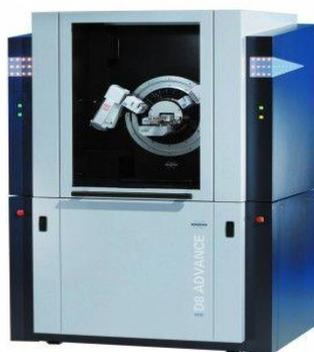
Рисунок 6 – Дифрактометр Bruker D8 AdvanceEco
