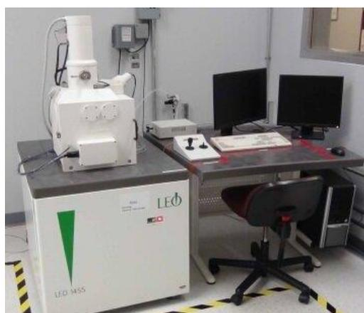
Рисунок 5 – Микроскоп LEO 1455 VP
