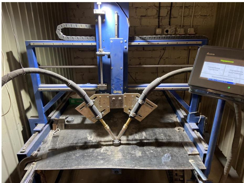
Рисунок 2 – Установка для двухдуговой наплавки
