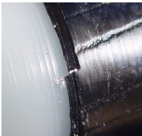
Рисунок 12 – Образец некачественного снятия экранирующего слоя
