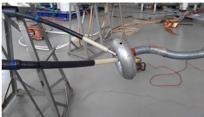
Рисунок 5 – Подключение испытуемой кабельной сборки к источнику высокого переменного напряжения MSR–600 и измерителю ЧР DDX 800
