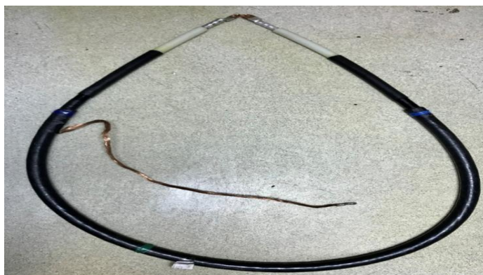
Рисунок 4 – Образец кабеля АПвП 1×95–35 кВ для испытания материалов и образцов концевых и соединительных муфт
