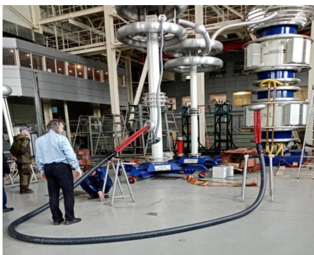
Рисунок 25 – Подключение концевых муфт к измерителю частичных разрядов DDX 8003
