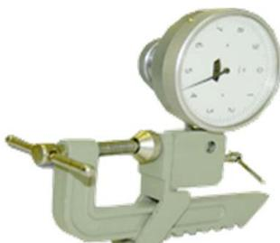
Рис. 15. Внешний вид прогибомера Максимова со струбциной
