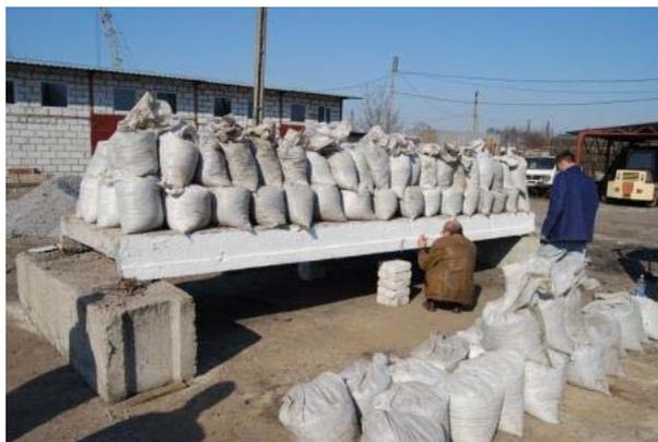
Рис. 7. Испытание плиты распределённой нагрузкой
