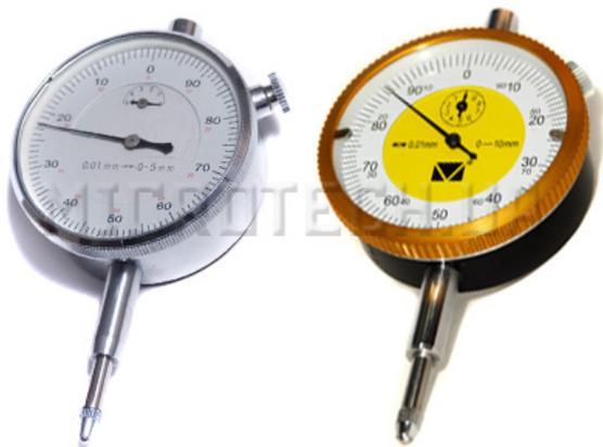
Рис. 24. Внешний вид индикаторов часового типа ИЧ-10
