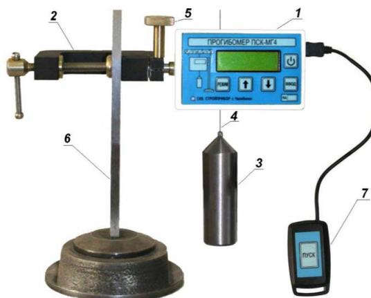
Рис. 27. Общий вид прогибомера
