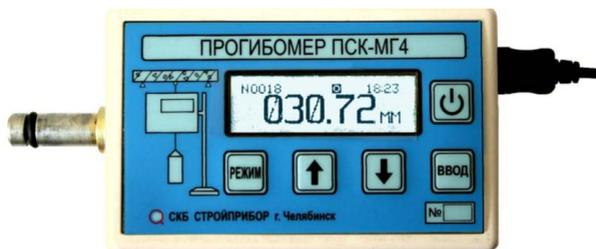
Рис. 28. Вид электронного блока прогибомера
