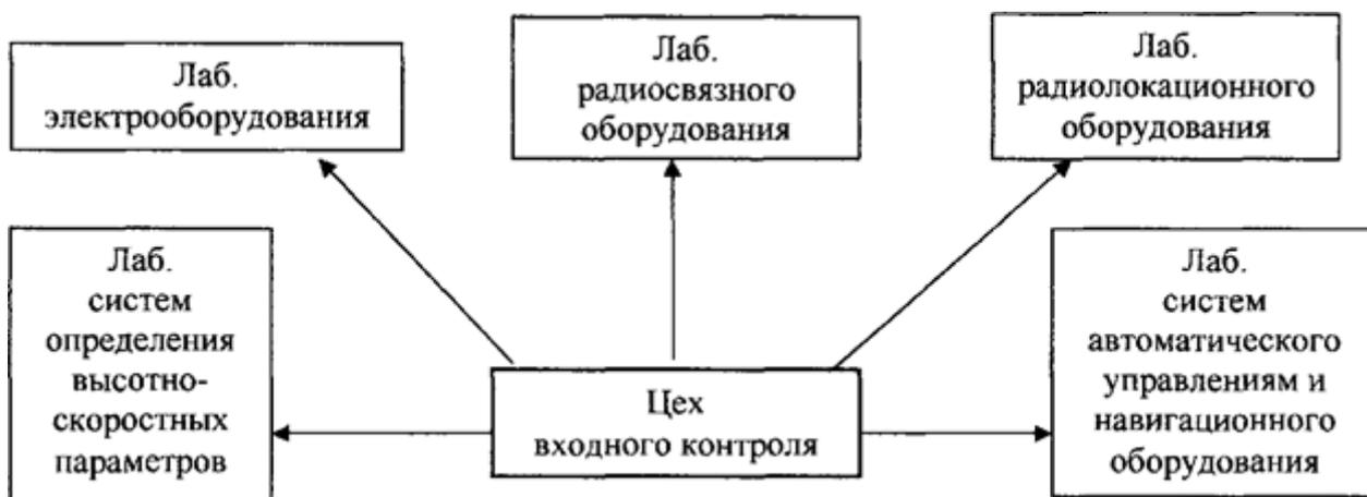
Рисунок 2 - Организация входного контроля систем и агрегатов пилотажно-навигационного комплекса
