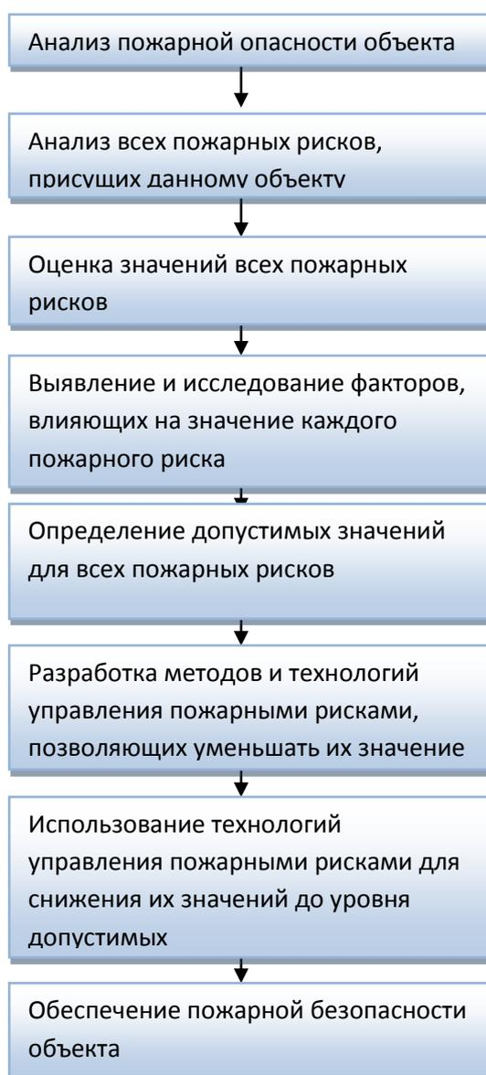
Рисунок 19 – Алгоритм управления пожарной безопасностью объекта
