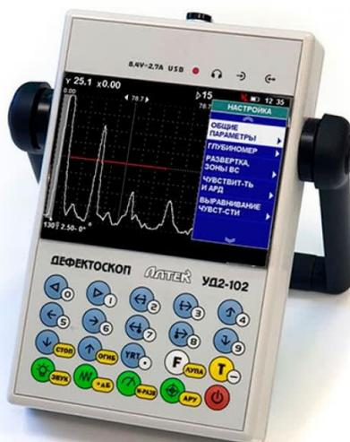
Рисунок 5 – Ультразвуковой дефектоскоп УД2-102
