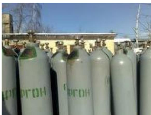
Рисунок 4 – Баллоны для аргона
