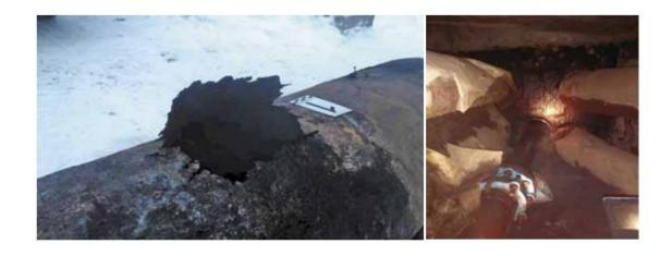
Рисунок 3 – Разрыв трубы в ООО «Пермская сетевая компания»
