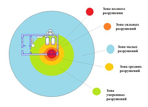
Рисунок 6- Зоны действия поражающих факторов на здания и сооружения
