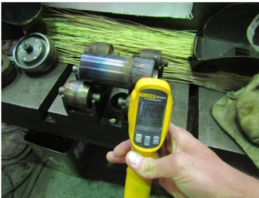
Рисунок 23 – Контроль температуры наплавленного металла
