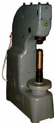
Рисунок 15 - Внешний вид твердомера ТШ-2М
