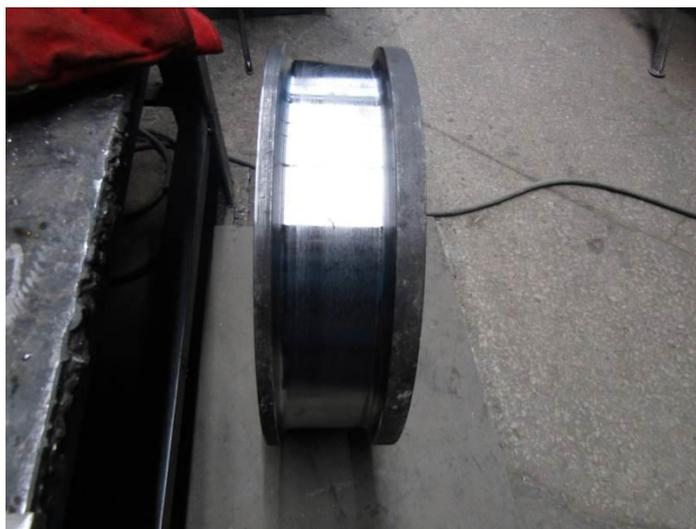
Рисунок 25 - Изношенное крановое колесо диаметром 450мм
