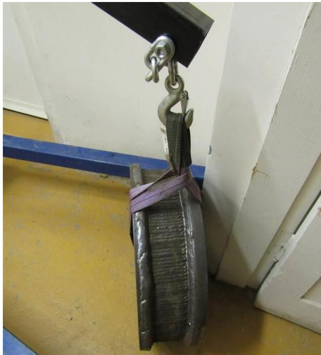
Рисунок 29 – Подготовка к транспортировке колеса в печь
