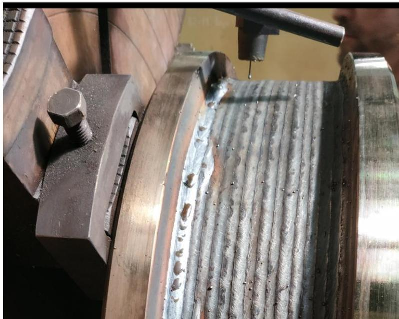
Рисунок 33 - Колесо на вращателе после наплавки
