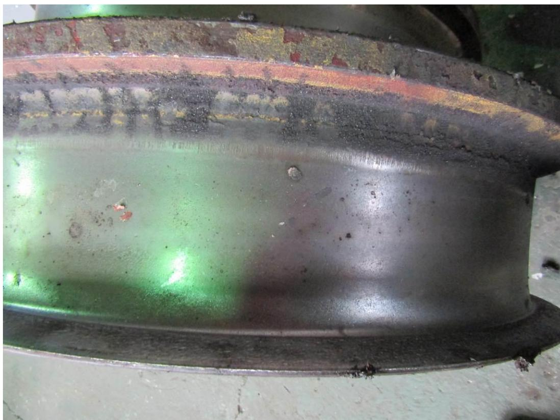
Рисунок 2 – Изношенное колесо мостового крана
