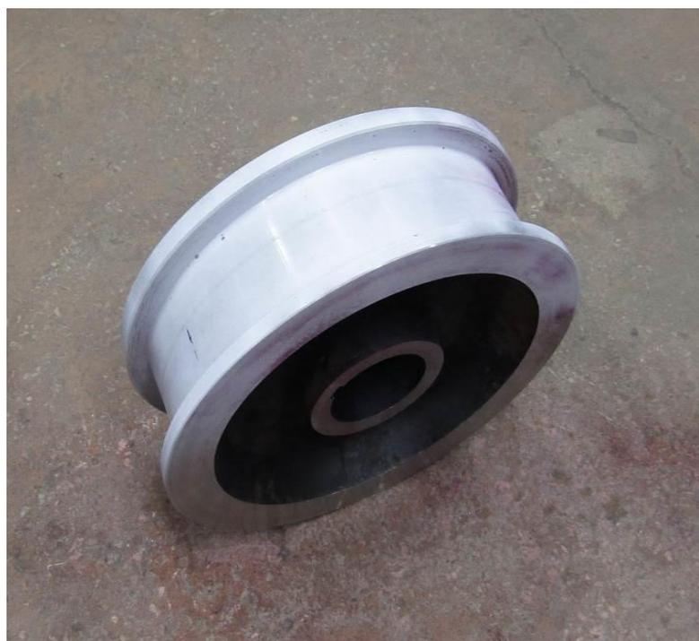
Рисунок 34- Колесо после магнитно-порошкового контроля
