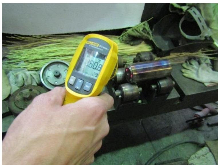
Рисунок 22 – Контроль температуры образца
