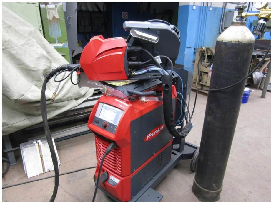
Рисунок 5 – Внешний вид сварочного аппарата TPS 400i
