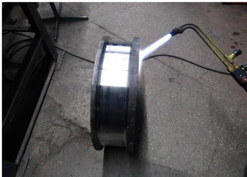
Рисунок 26 - Преварительный нагрев образца №2
