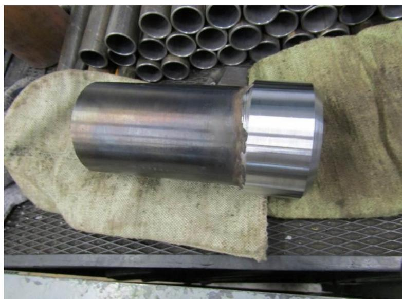
Рисунок 24 – Тестовый образец после механической обработки
