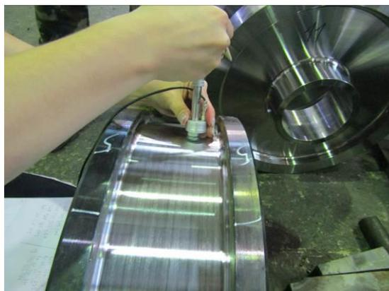
Рисунок 37 – Измерение твердости на поверхности катания
