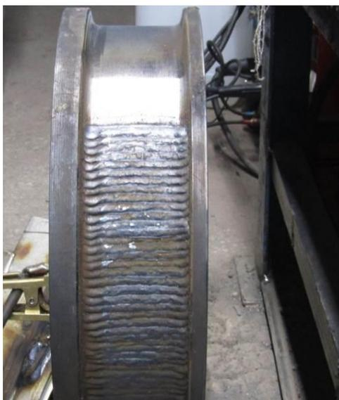
Рисунок 28 – Частично наплавленное колесо
