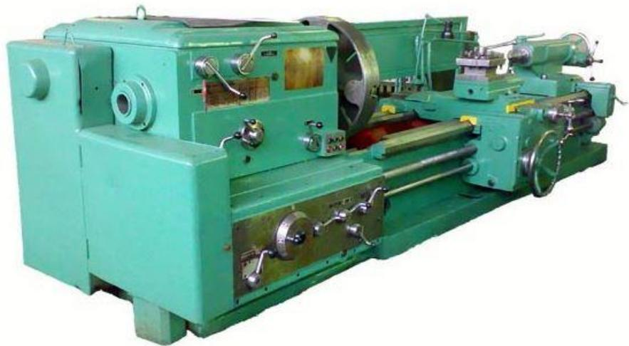
Рисунок 8- Внешний вид токарно-винторезного станка 1А64
