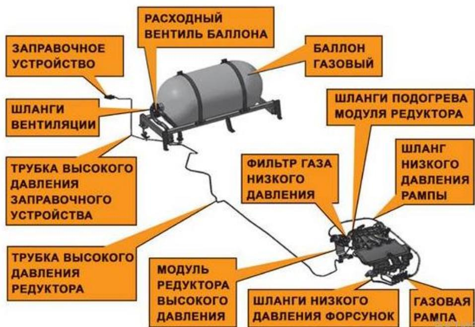
Рисунок 2 – Компоновка оборудования для подачи природного газа
