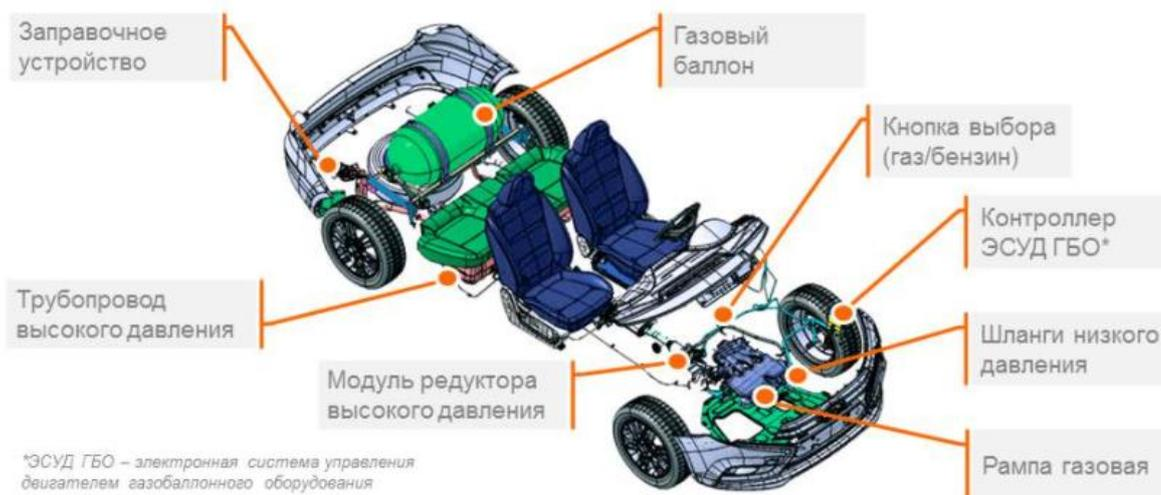
Рисунок 3 – Компоновка оборудования LADA Vesta CNG
