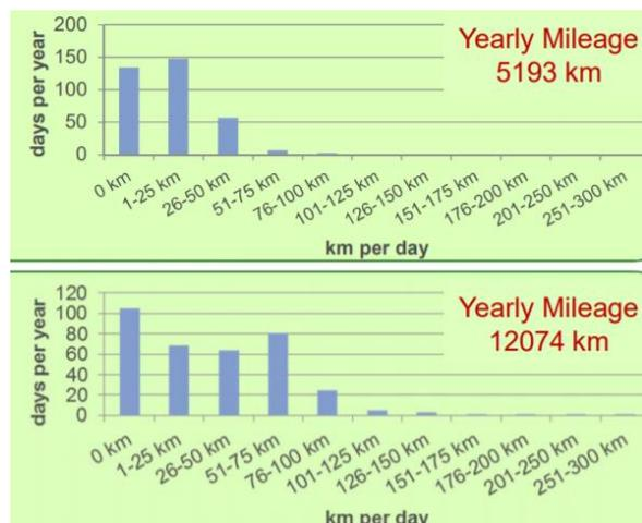
Рисунок 2.11 – Минимальный и максимальный годовой пробег автомобиля (Германия).
