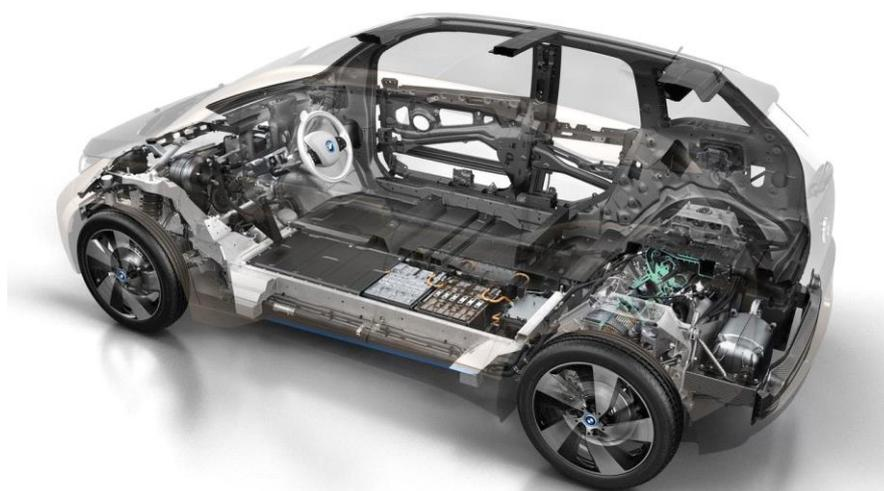
Рисунок 2.5 - Схема компоновки автомобиля BMW i3
